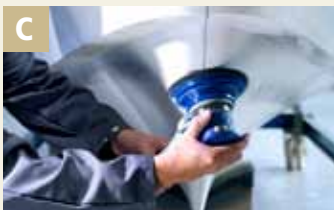
C Coarse sanding of primer filler/gelcoat
