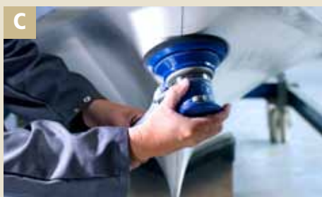
C Coarse sanding of primer filler/gelcoat
