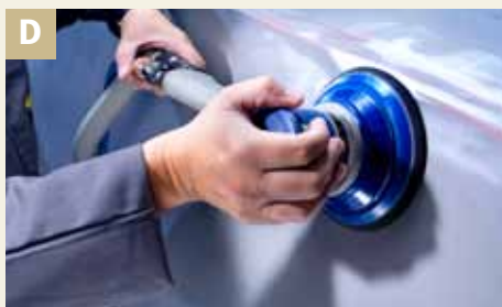
D Fine sanding of primer filler/gelcoat
