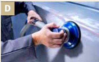
D Fine sanding of primer filler/gelcoat
